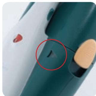
Si le champ de l'indicateur de puissance d'aspiration est entièrement jaune cela signifie que les pores du sac filtre sont bouchés. La puissance d'aspiration diminue tellement qu'il est nécessaire de changer le sac filtre. Il faut également changer le sac filtre lorsque le Kobold fait beaucoup plus de bruit que d'habitude.
